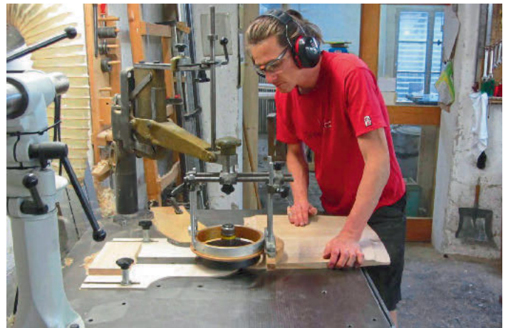
/ Flexibel einstellbar: Auch eine Fräsbrille mit oberem Andruck- und Schutzring kam – wie hier bei der Bearbeitung der geschwungenen Türfüllungen – zum Einsatz.
